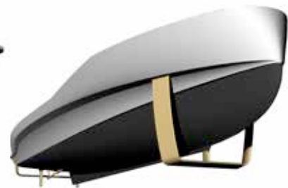
De Gran Displacement met Hull Vane Assist.
