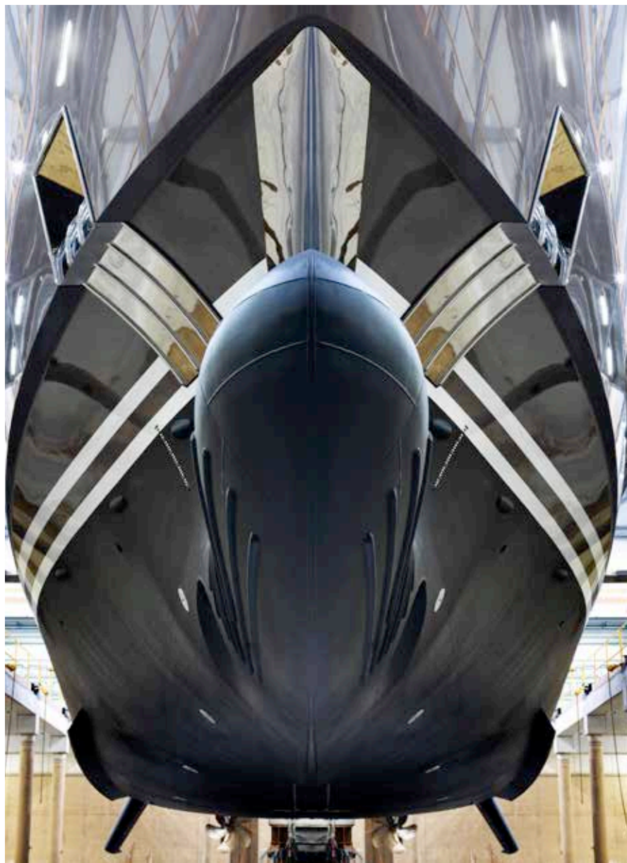
De bulbsteven van de door Heesen gebouwde Alive.
