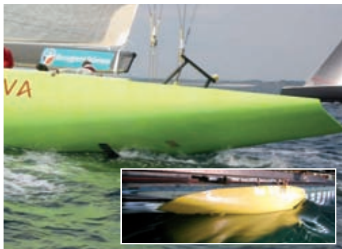
Figuur 3. Beproeving Hull Vane op een America's Cup-jacht in 2002. De tip van de vleugel komt bij grote hellingshoeken net boven water.
