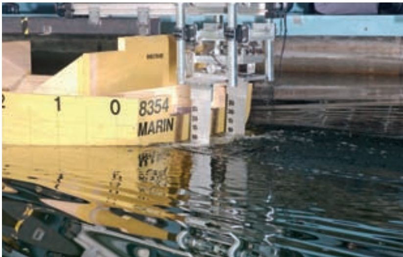
Figuur 5. Beproeving van de Hull Vane op het model van het 170 m containerschip van Wagenborg in de sleeptank van het Marin in 2006. De opstelling van de Hull Vane was zodanig dat de langs- en hoogpositie van de Hull Vane kon worden versteld. De zes-componenten-dynamometer is rechtstreeks aan de Hull Vane gemonteerd.
