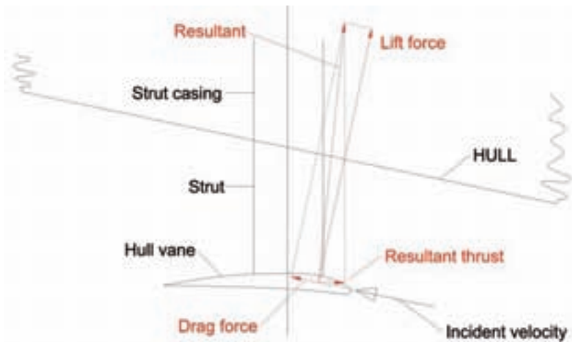
Figuur 1. Principe van de Hull Vane. Indien de stroming onder het schip voldoende "hoek" maakt met de horizontaal, wordt er bij een efficiënt ontwerp van de vleugel voldoende stuwkracht opgewekt om brandstof te besparen.
