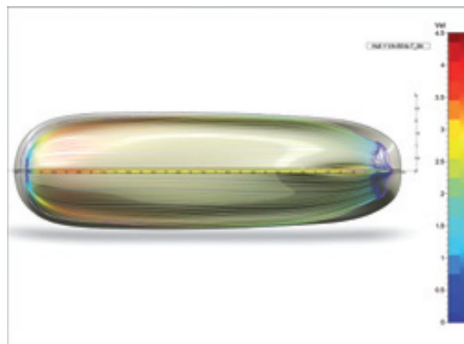
Figuur 3. Stroomlijnen op de romp van een traditionele Lemsteraak
