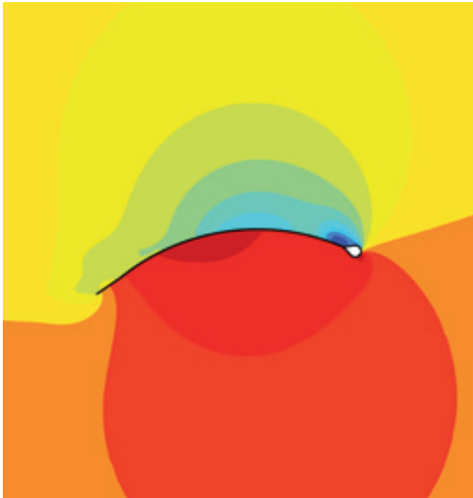
Figuur 7. Drukopbouw rond een doorsnede op een mast met grootzeil
