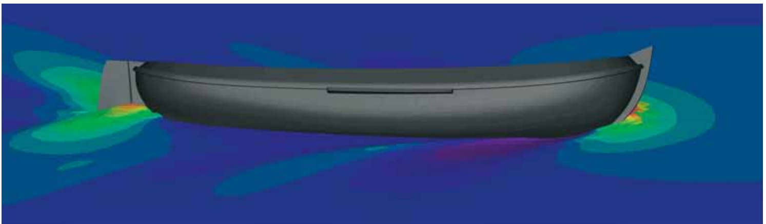
Figuur 3. Berekend golfpatroon aan loefzijde. Onder: Figuur 4. Berekend golfpatroon aan lijzijde
