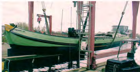
Figuur 10. Te water laten van het verlengde en geknikte schip.
