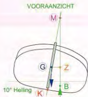
Figuur 12. Het zwaartepunt G moet "links" van het zgn. drukingspunt B liggen in het geval van een stabiel schip. De horizontale afstand GZ tussen de werklijnen van het gewicht door G en de oprijvende kracht door B wordt de stabiliteitsarm - ook wel de oprichtende arm - genoemd.
