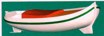
Figuur 4. Drie-dimensionaal model gebruikt als basis voor het bepalen van de invloed van diverse componenten op de stabiliteit.
