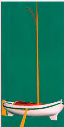
Figuur 5. Drie-dimensionaal model gebruikt voor het bepalen van het (cumulatieve) effect op de stabiliteit van zwaard, zwaardklamp, roer, dikte van het houten dek, kuipbanken, luiken en koekoeken, mast en gaffel.
