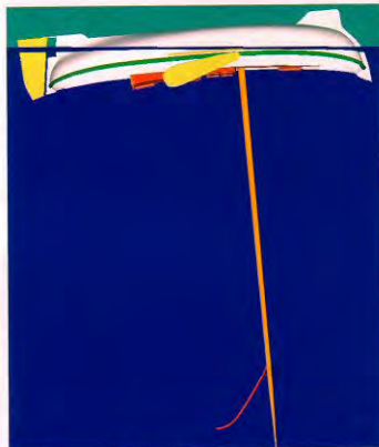
Figuur 10. Ligging van de Lemsteraak indien het waterdichte compartiment op tijd is "afgesloten" en ook de ventilatieopeningen van de machinekamer en de voorpiek waterdicht/afsluitbaar zijn.
