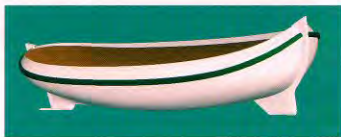
Figuur 1. Computermodel van de Lemsteraak die voor de uitgevoerde studie is gebruikt, voorzien van een fictief dek, zoals gebruikelijk is bij veel stabiliteitsberekeningen.
