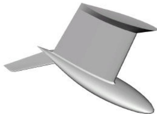
*figure 1 New keel for X-73.*
